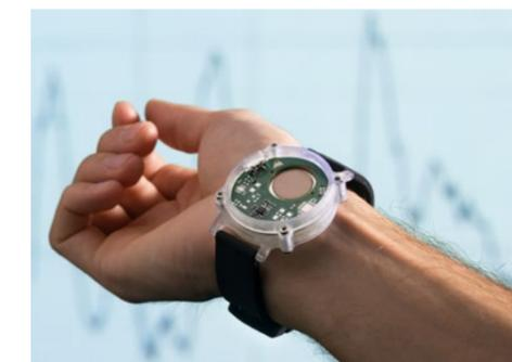
Tragbare Blutdruckmessung mit Mikropumpen der Fraunhofer EMFT
