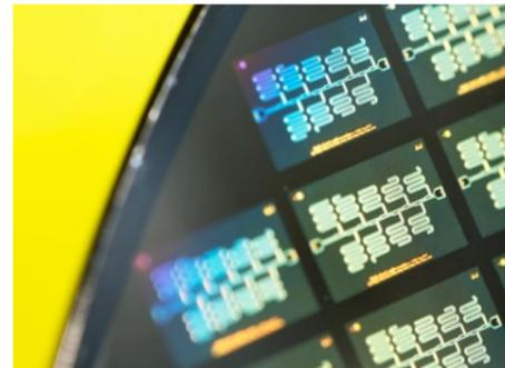
Resonatoren zur Materialanalyse für supraleitende Qubits auf 200 mm Wafer mit Nb-Beschichtung
