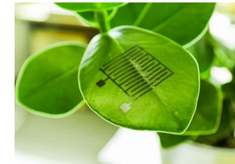
*Sensoren auf Basis organischer Halbleiter zur Überwachung der Vitalität von Pflanzen und als Indikatoren für parasitären Befall*
